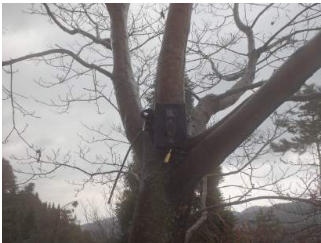
写真8：調査に使用した自動撮影カメラ（Ltl-Acorn社製の「Ltl-Acorn Ltl-6210MC」）
